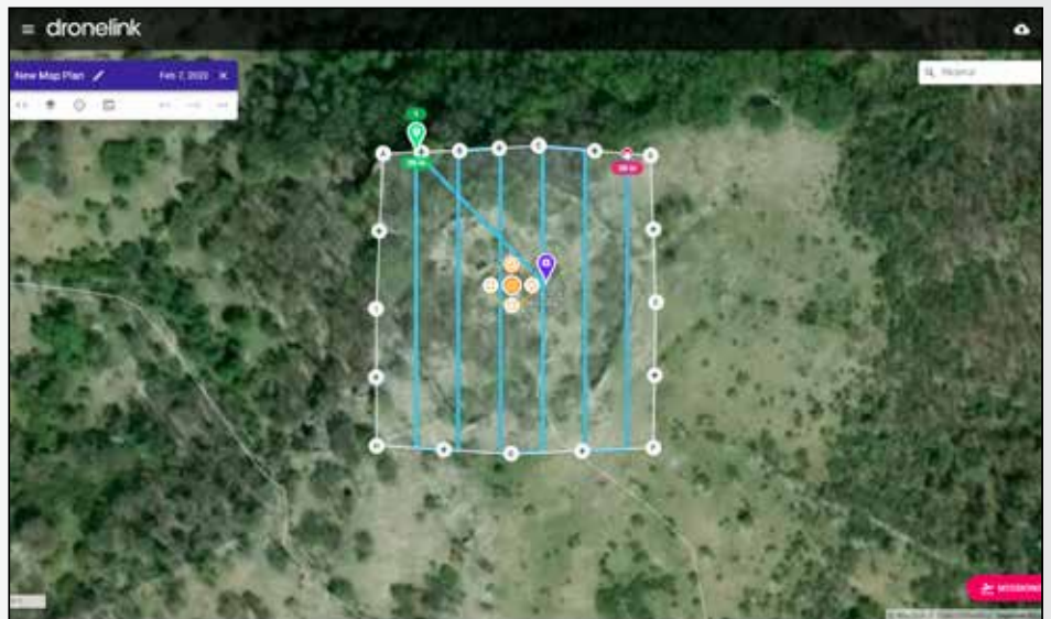
Fig. 3 - Piano di volo eseguito dal drone nel febbraio 2022 (app web Dronelink).
