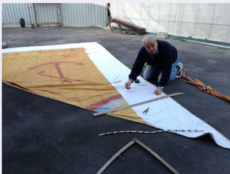
21. Al lavoro per modificare e disegnare una vela al terzo.jpg
